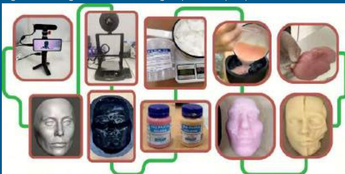
Figura 3: Diagrama do processo de confecção, validação e teste laboratorial do simulador de face, iniciando da imagem superior esquerda até a última imagem na região superior direita.
