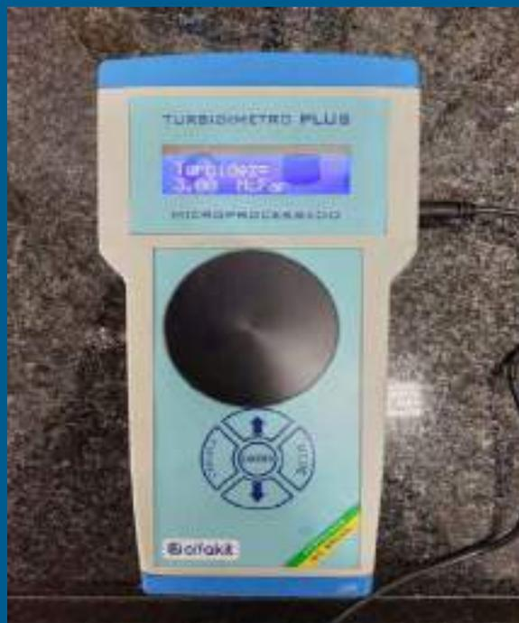
Imagem 1: turbidímetro com a escala McFarland.
